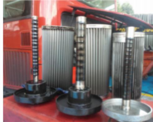
**Figura No. 4** – Elementos de Ecofiltros al recorrido de 10.000 km
