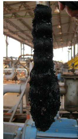
**Figura No. 7** – Rodete magnético con contaminación ferrosa y no ferrosa en patín de descargadero de carro-tanques con nafta.
